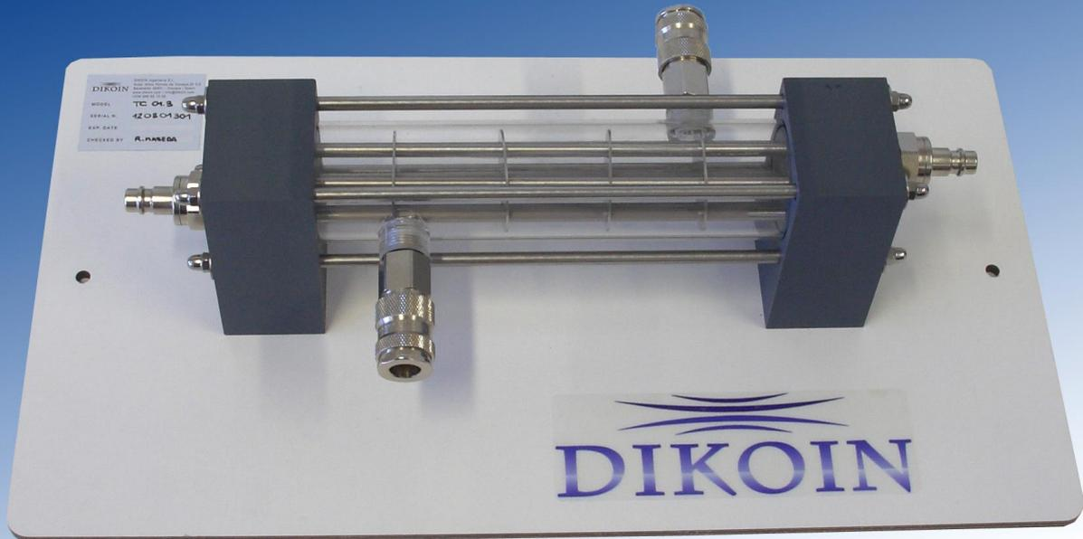
Intercambiador diseñado para trabajar sobre (requerido): TC 01.1 UNIDAD DE SUMINISTRO DE INTERCAMBIADOR DE CALOR
